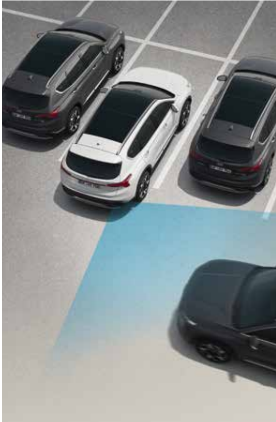
Querverkehrswarner hinten mit Bremsengriff (RCCA). 1 Beim Rückwärtsfahren aus Bereichen mit schlechter Sicht warnt Sie der Querverkehrswarner vor seitlich heranfahrenden Fahrzeugen und bremst bei Bedarf automatisch ab.
