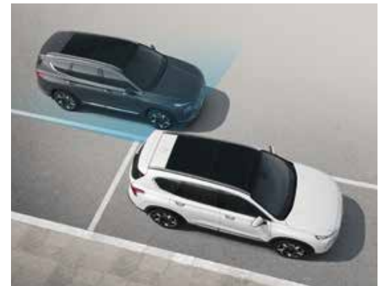
Aktiver Totwinkelassistent (BCA). 1 Der aktive Totwinkelassistent nutzt Radarsensoren im unteren hinteren Stoßfänger und eine Kamera, um Sie vor Verkehrsteilnehmern im toten Winkel zu warnen und eine Kollision zu verhindern. Sollten Sie trotz Warnhinweisen trotzdem versuchen, die Spur zu wechseln, erfolgt zur Vermeidung einer Kollision automatisch ein Lenk- und Bremsengriff.
