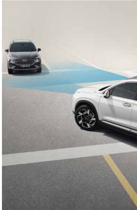
Autonomer Notbremsassistent (FCA, Abbiegen an Kreuzungen). Der Notbremsassistent warnt Sie und bremst automatisch, wenn ein Fahrzeug vor Ihnen plötzlich bremst, wenn er Fußgänger oder Radfahrer auf Ihrem Weg erkennt oder wenn beim Linksabbiegen an Kreuzungen Fahrzeuge entgegenkommen.
